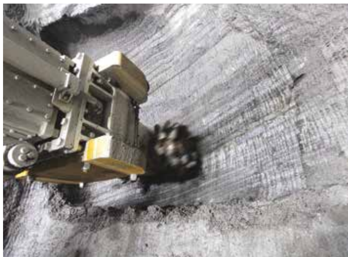
2 e 3. La testa fresante Simex TF 3000 ha fatto riscontrare ottime produzioni anche in presenza di materiali con resistenza intorno ai 180 MPa, che in alcuni tratti hanno raggiunto punte di 200 MPa
