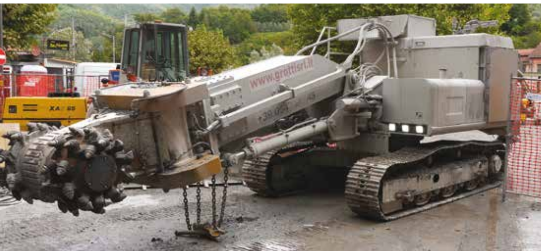
4. La GTF 400 RC con tecnologia MultiRadius Pro dotata di testa fresante Simex TF 3000
